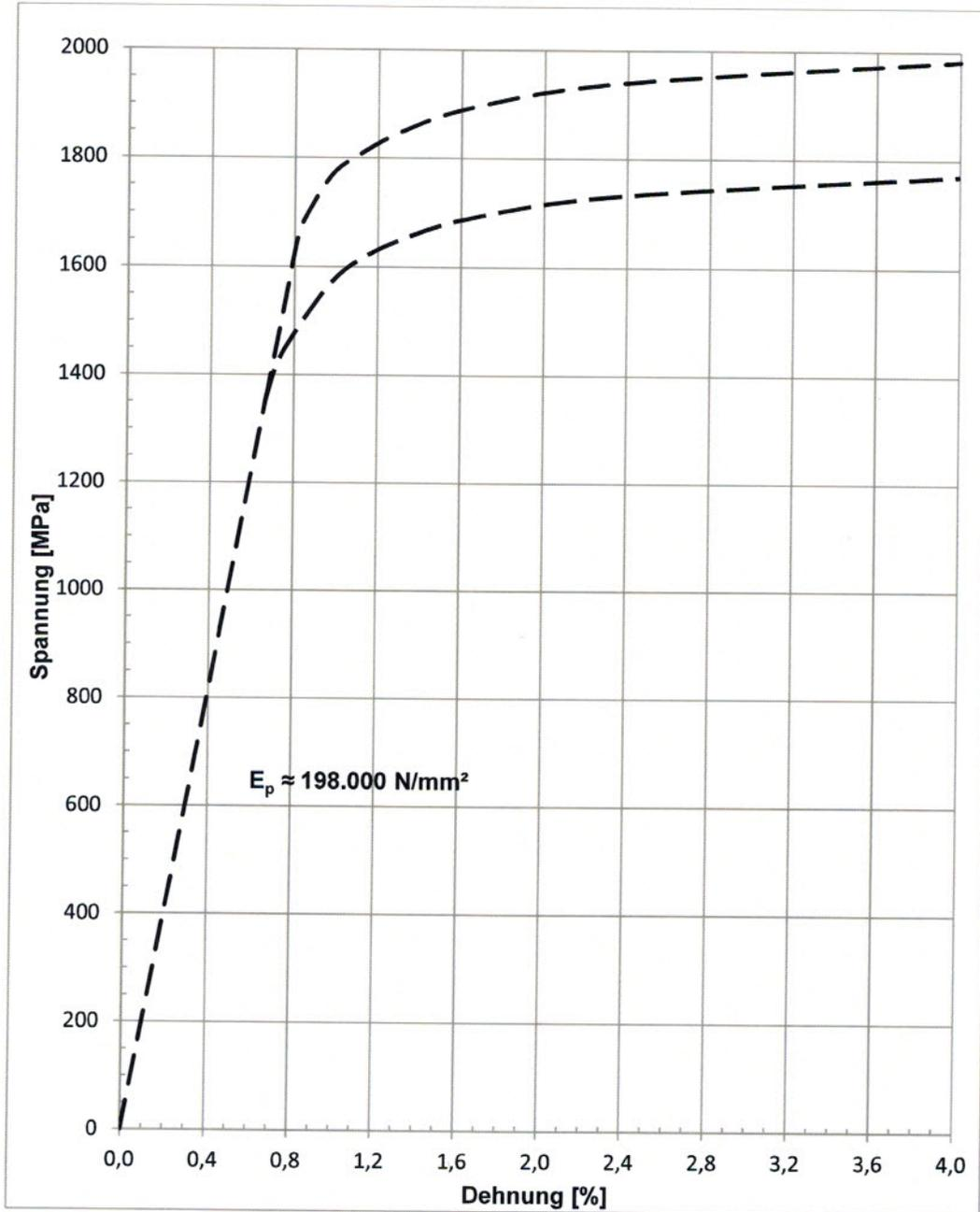
Die Linien geben eine Orientierung für den prinzipiellen Spannungs-Dehnungs-Verlauf bei Annahme des Rechenwertes des E-Moduls ( $E_p$ ) von 198.000 N/mm<sup>2</sup>.
