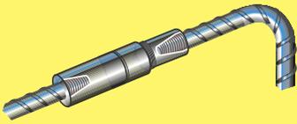
Die Muffen vom Typ P13LN bzw. P8 sind für die Verbindung von gekröpften, gebogenen oder geraden Stäben konzipiert, wenn keiner der Stäbe gedreht werden kann und die Bewegung des anzuschließenden Stabes in axialer Richtung eingeschränkt ist. Typische Anwendungen sind: End- oder Schlußverbindungen oder Verbindungen zwischen zwei Fertigteilen.
