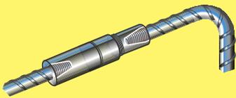
Die Muffen vom Typ P14LN und P9 sind für die Verbindung von gekröpften Stäben konzipiert, wenn keiner der Stäbe gedreht werden kann und der anzuschließende Stab sich in axialer Richtung frei bewegen läßt. Typische Anwendungen: Gekröpfte Stützenbewehrung.
