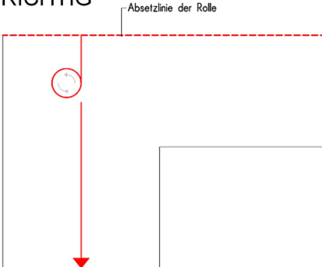
Das letzte Bild macht deutlich, daß kein Ausrollproblem entsteht, wenn das Element – bei Blick in Ausrollrichtung – links und rechts nirgendwo breiter als bei der Absetzlinie ist.
