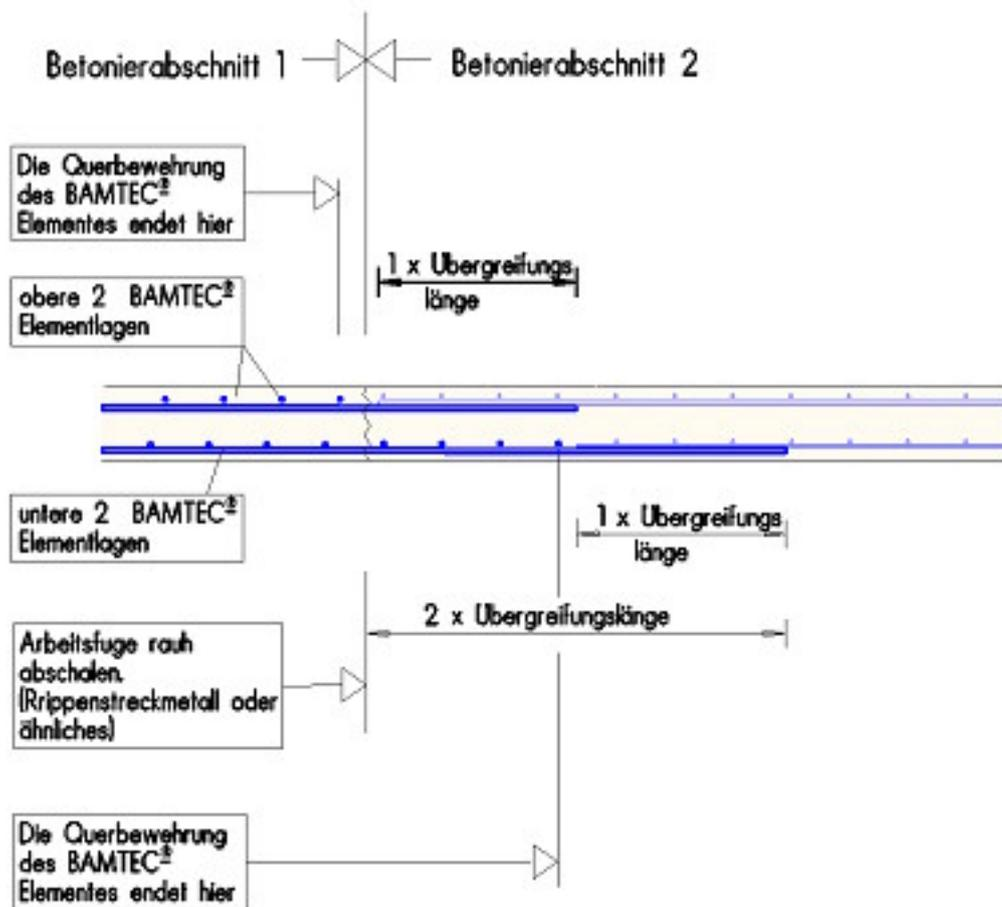
Im Bereich der Übergreifungsstöße werden die Quereisen des zuerst betonierten Abschnittes ausgespart. Dadurch ist es möglich, dass die BAMTEC<sup>®</sup> Elemente die gleiche Höhenlage haben.
