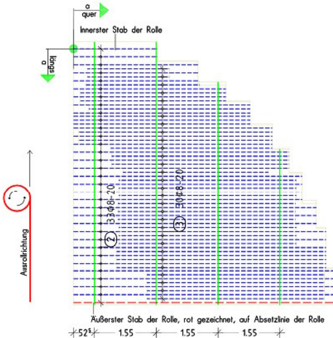
Es gibt Situationen (z.B. um die erwähnte Befestigung jedes Stabs an mindestens zwei Bändern zu erreichen), wo der BAMTEC-Software-Benutzer von der Möglichkeit des Programms Gebrauch macht, die Bänder dieses Elements alle um das gleiche Maß zu verschieben. Dann ragt das Element an der Definitionspunkt-Seite weniger als 525 mm über das Randband der Maschine hinaus und die mögliche Elementbreite ist kleiner als 15.000 mm.
