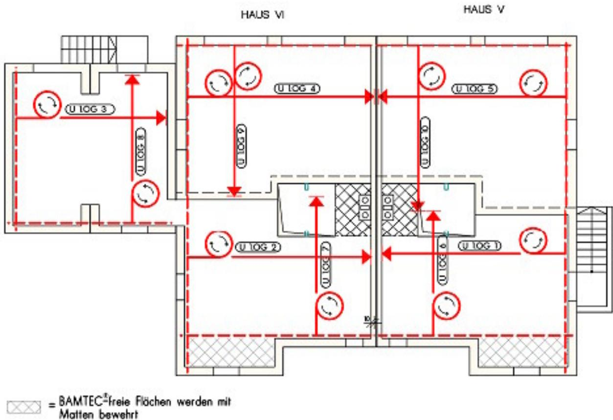
Hier werden, richtig, möglichst große BAMTEC-Elemente verwendet. Übrig bleibende kleine Flächen sind einfach mit Matten bewehrt.
