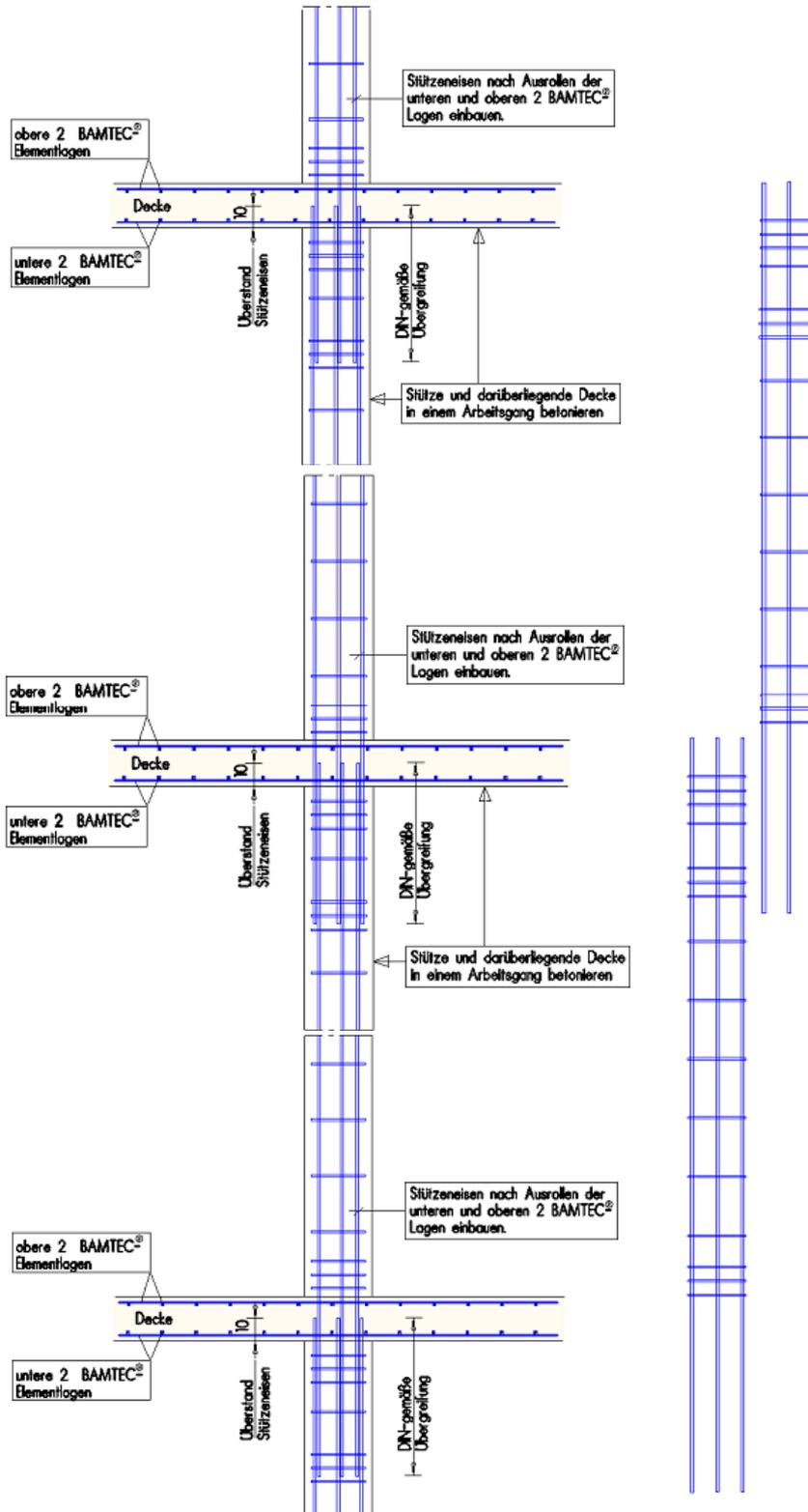
Anschluss an Ortbetonstütze Variante 3 b
