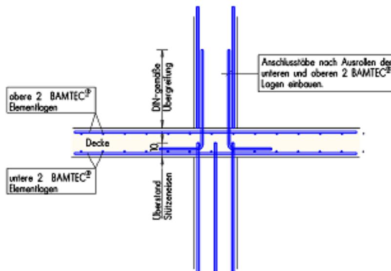
Anschluss an Ortbetonstütze Variante 3 a
