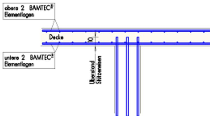
Anschluss an Ortbetonstütze Variante 2
