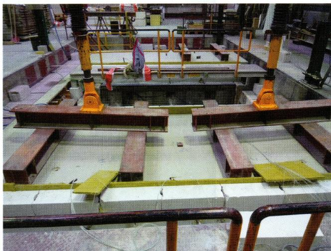
Zustand nach 120 Minuten: die Prüfdecke hatte sich unter der hohen Last 15 cm durchgebogen und die Temperatur in der Brandkammer betrug 1.034 °C
