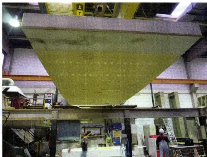
Abheben der Decke nach Versuchsende und Sichtkontrolle: außer einigen kleinen, oberflächlichen Abplatzungen waren keine Beschädigungen zu erkennen
